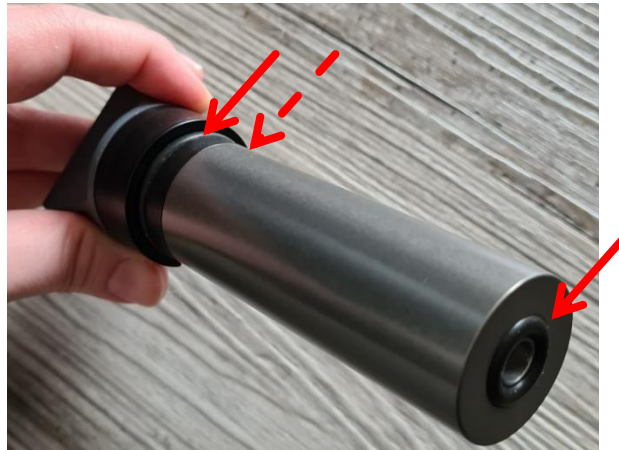
Abbildung 4: Dichtringe an der der Alkoholkartusche
