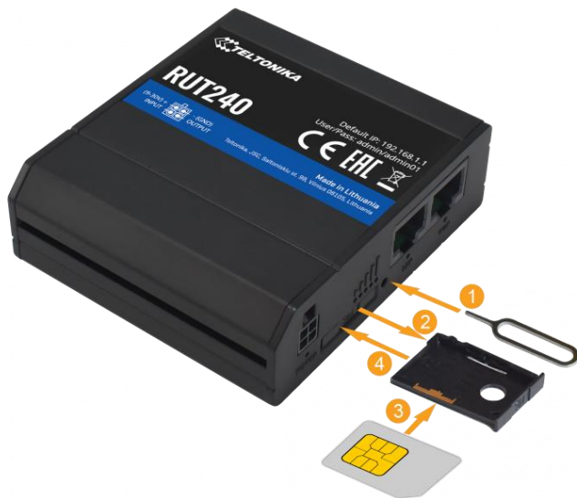
Figure 10 : Mise en place de la carte SIM
