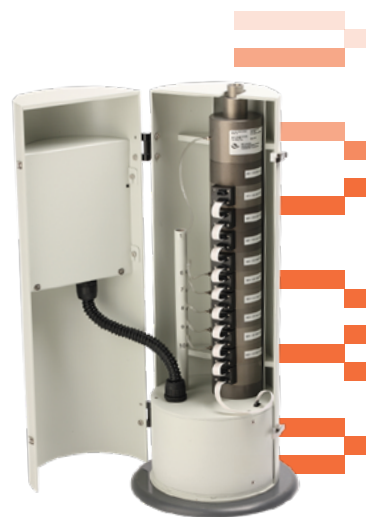
图示120R MOUDI™撞击式分级采样器
