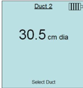
Si fanno regolazioni con i tasti ▲ o ▼ e si preme ← per accettazione, o si inserisce il menu **Select Duct** o **Select Kfactor** per scegliere un diverso valore pre-programmato della portata o una dimensione.
