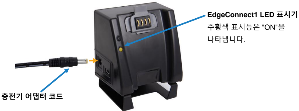
그림 2-5: EdgeConnect1 에 충전기 어댑터 연결 (모델 EG3, EG4, EG5 의 경우 EdgeDock1 사용)
