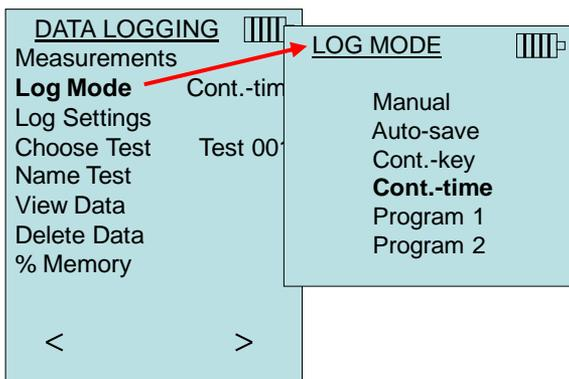
Cuando se establezca **Cont-time**, se puede ajustar el intervalo de registro y la longitud de la prueba.
