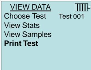
El 7575 puede enviar estos datos a la impresora inalámbrica opcional Modelo 8934 o PC con comunicación Bluetooth®. Para utilizar el comando **PRINT (IMPRIMIR)**, deberán fijarse comunicaciones de Bluetooth® entre el Modelo 7575 y la impresora inalámbrica opcional Modelo 8934 o PC configurado con comunicación Bluetooth®.
