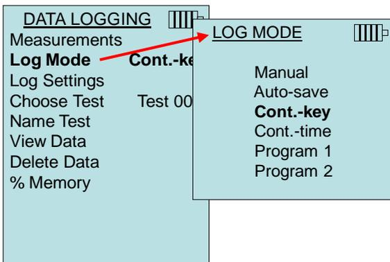
Cuando se establezca en **Cont. key**, se podrá ajustar el intervalo de registro y la longitud de la prueba.
