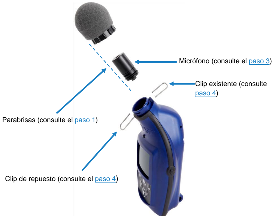
Figura 6-1: Montaje de micrófono y parabrisas
