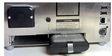
4. 只有在仪器开机(休眠)时，电池才会充电。如果您经常将设备与电池配合使用，可以考虑购买 TSI®外置双电池充电器型号 DBC-A100(请参阅第 1 章的可选附件)。
