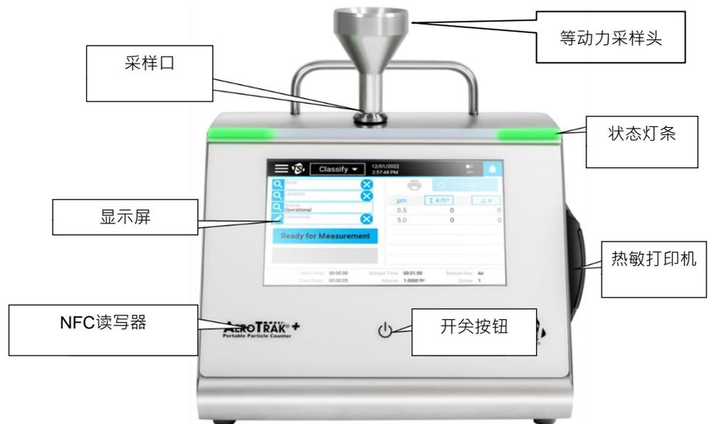
触摸屏显示器提供直观的图形用户界面(GUI)。当仪器打开时, LED灯条会同步点亮,并在采样期间提供状态信息。在面板的左下方,在 AeroTrak™+便携式粒子计数器标签下,是近场通信(NFC)读写器,提供非接触通信。
