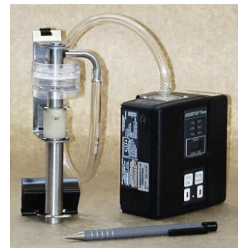
配备呼吸性硅尘采样系列组件的采样泵
