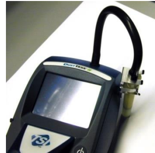
配备Dorr-Oliver 呼吸性粉尘旋风分离器的TSI 手持式DustTrak II型监测仪
