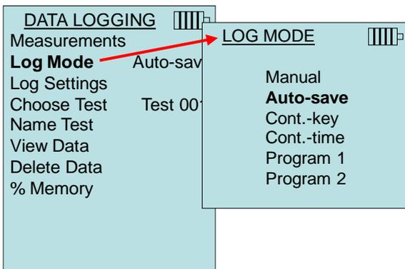
Bei der Einstellung **Auto-Speich.** kann die Dauer der Probenahme angepasst werden. Probenahmezeit bezieht sich auf die Zeit, anhand der der Mittelwert der Probe errechnet wird.
