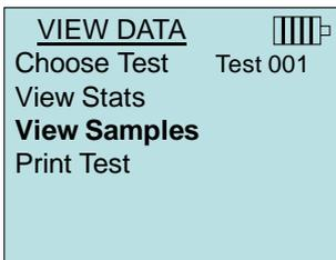
Verwenden Sie die Pfeiltasten links/rechts, um die Messwerte aller gemessenen Parameter innerhalb einer Test ID anzusehen.
