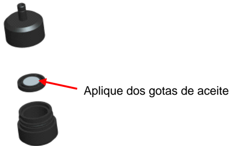
Figura 4-4: Aplicar 2 gotas de aceite a la lámina del impactador
