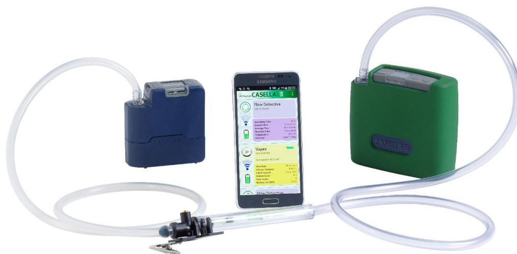
VAPex nella taratura a circuito chiuso
