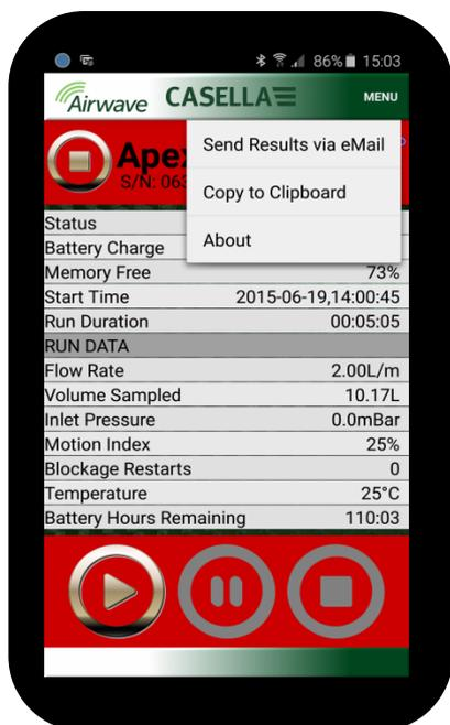
菜单包含许多选项，可以通过设备的电子邮件或各种剪贴板设备方便地传输测量结果。
