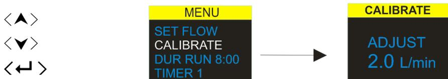
要执行单点校准，请将采样头或流量管或其他流量测量设备安装到泵的入口管嘴处，然后选择此选项来进行校准。
