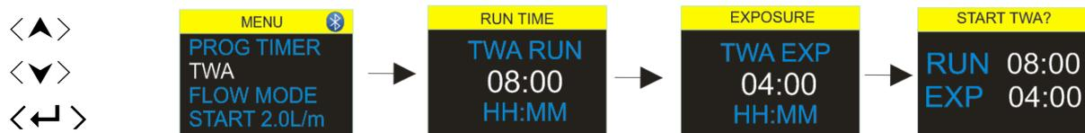
**时间加权平均值 (TWA)** 模式允许泵在指定的总运行时间内对固定的时间比例进行采样。设备计算所需的
