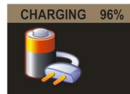
正在充电的显示器超过用户所定义的显示器超时后将会变为黑屏。按下“电源”按钮将“唤醒”显示器，进入下一个间隔，直到再次超时。充电完成后，将显示实心的蓝色 LED 指示灯 10 分钟，10 分钟过后，泵将关闭电源。
