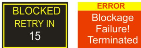
**阻塞重试：** 如果泵无法保持目标流量在 5% 以内的时间超过 20 秒钟（由于所述检测管扭结或入口阻塞），则它将会自动停止采样。一分钟后，泵将尝试重启。如果指定的重试尝试次数不成功，则泵将终止当前的采样运行。
