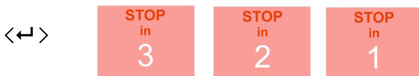
要停止或暂停采样运行，请按住 Enter 键 <↵>，系统将显示倒计时屏幕。要退出“停止”操作，请在倒计时过程中随时松开 Enter <↵> 键。系统将显示操作面板显示器。
