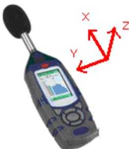
X liegt in der Richtung zum Mikrofon, Z liegt in der Richtung der Anzeige und Y liegt in der Richtung seitlich vom Gehäuse.
