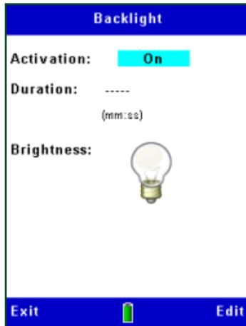
Die Hintergrundbeleuchtung ist entweder dauerhaft eingeschaltet oder wird nach einem Tastendruck für eine bestimmte Dauer in Minuten und Sekunden eingeschaltet (siehe Abbildung 17).
