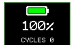
显示电池充电百分比后，将出现带有即时和平均流量的操作面板屏幕。
