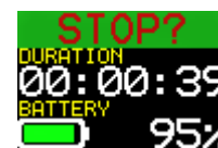
Affichage à code de couleurs présentant la durée de vie de la batterie
