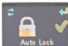
Para bloquear (e desbloquear) manualmente, pressione e segure a tecla direita por 2 segundos e, enquanto mantém pressionada a tecla direita, pressione a tecla esquerda 3 vezes em sucessões rápidas.
