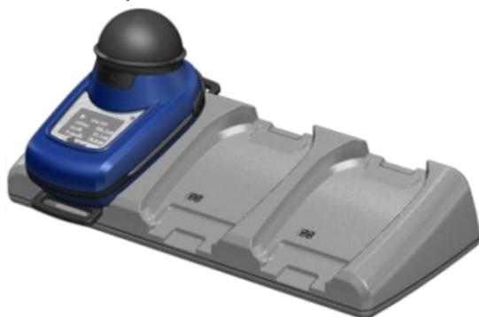
O dBadge2 exibirá o status de carregamento e apagará depois de aproximadamente 20 segundos; o indicador LED de status piscará intermitentemente na cor vermelha durante o carregamento e ficará azul sólido quando ele estiver completamente carregado. Para “acordar” o display durante o carregamento, pressione uma das teclas ou incline a estação de acoplamento para a frente.
