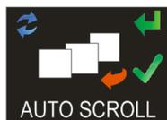
Wenn gewählt, rollt das Display automatisch von einer Anzeige zur nächsten (sonst muss die Anzeige von Hand vorwärtsbewegt werden). Drücken Sie die rechte Taste zum Akzeptieren oder die linke Taste, um zu wechseln.
