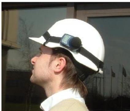
Sie können den dBadge2 auch an einen Gurt (Stücknummer D8147/Z) befestigen, indem Sie den Gurt durch die leere Schnalle ziehen (Stücknummer 207073B). Benutzen Sie die Ansteckbefestigung für alle bereits vom Mitarbeiter getragenen Gurte. Weiter kann der dBadge2 auch an den meisten Schutzhelmen angebracht werden. Hierfür benutzen Sie das Befestigungskit (Stücknummer CEL-6354) und Stecknadeln. Der Satz besteht aus einer Schlaufe mit 4 Haken, die am den Rand des Schutzhelms befestigt werden.
