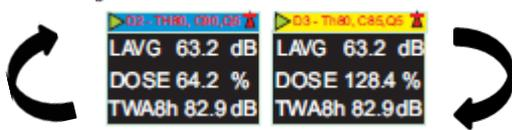
D1 ist der Hauptdosimeter der ausgewählten Dosenwerte sowie andere Lärmparameter (Spitze, max. usw.) berichtet. D2 und D3 bieten zusätzliche Einrichtungen. Die Kopfzeile für D1 Messungen ist die Hintergrundfarbe, D2 weist eine blaue Kopfzeile und D3 eine gelbe Kopfzeile auf.
