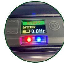
带红色/蓝色 LED 指示灯的 OLED 全彩显示屏显示采样泵的状态, 可从远处查看
