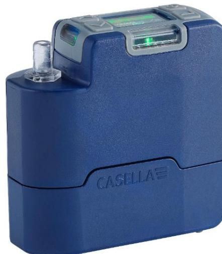
O VAPex foi projetado para aplicações de amostragem de fluxo particularmente baixo, com uma faixa de 20 a 500 ml/min e uma impressionante capacidade de contrapressão, o que garante que ele funcione de maneira confiável com uma ampla variedade de meios de tubos adsorventes. A pressão de entrada é continuamente detectada para estabelecer a carga do tubo adsorvente e ajudar no diagnóstico. A coleta de gás e vapor também é possível usando a saída da bolsa de gás na bomba.
