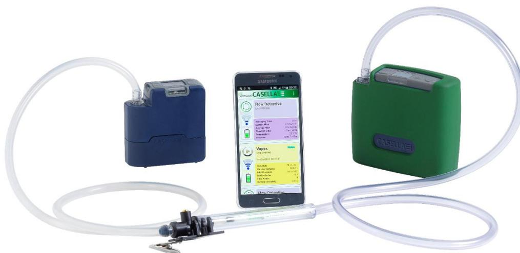
VAPex mostrado na calibração em circuito fechado
