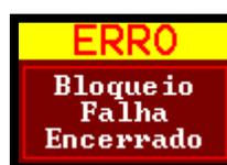
Após um minuto, a bomba tentará reiniciar. Se a bomba não tiver sido capaz de reiniciar após o número especificado de tentativas de repetição, a bomba encerrará o processo de amostragem atual e exibirá uma mensagem de erro.
