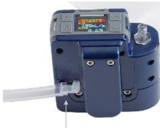
Ao usar a bomba para coletar gás, conecte o tubo da bolsa de gás à saída da bomba usando o acessório Luer fornecido.
