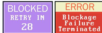
Au bout d'une minute, la pompe tentera de redémarrer. Si la pompe n'a pas pu redémarrer après le nombre spécifié de tentatives, la pompe va mettre fin à la séquence d'échantillonnage et afficher un message d'erreur.
