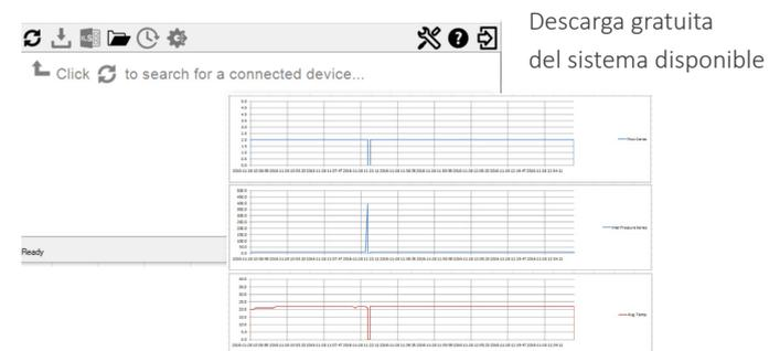
La VAPex puede almacenar hasta 200 sesiones distintas, guardando datos que incluyen la hora de inicio y parada, la fecha, la duración, el volumen de muestreo y el índice de movimiento.
