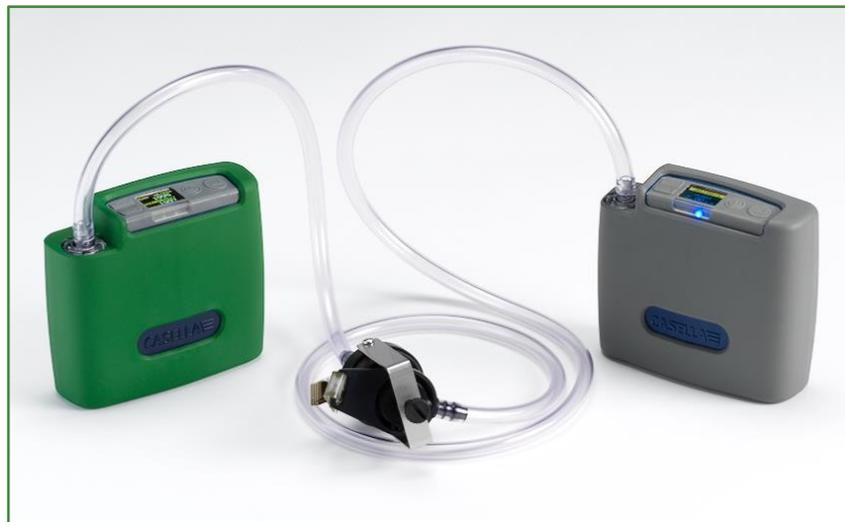
2. Vergewissern Sie sich, dass die Anschlüsse fest montiert sind und dass die Anschlusschläuche frei von Beschädigungen oder Rissen sind.
