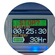
具备颜色标识的剩余电量显示
