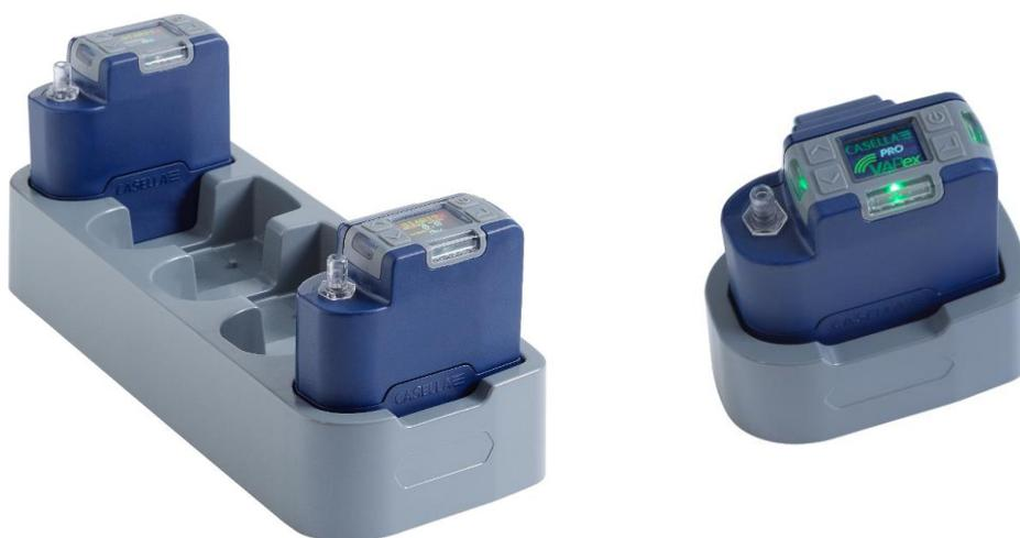
Los LEDs de la parte superior de la bomba parpadean según la cantidad de carga de la batería (ver *Indicadores LED* en la página 24) y el estado de la carga se muestra durante un periodo definido por el usuario.
