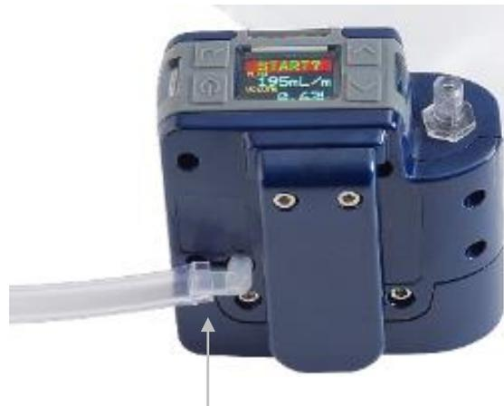
Al utilizar la bomba para la recogida de gas, conecte el tubo de la bolsa de gas a la salida de la bomba utilizando el acople Luer incluido.
