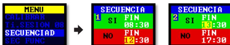
Se ejecuta una secuencia hasta que se ha configurado un periodo de **APAGADO** para **FINALIZAR**. En el ejemplo anterior, la bomba se enciende por la mañana y por la tarde con una parada de una hora durante el descanso de la comida del usuario.
