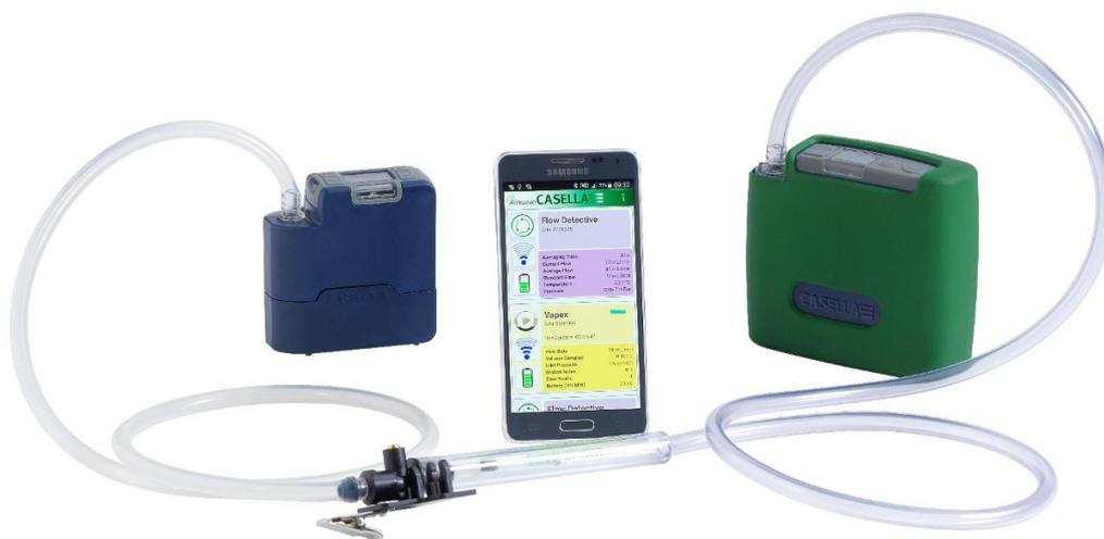
VAPex en una calibración en bucle cerrado
