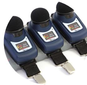
Les chargeurs 3 triphasés peuvent être raccordés ensemble et servir également de station de téléchargement
