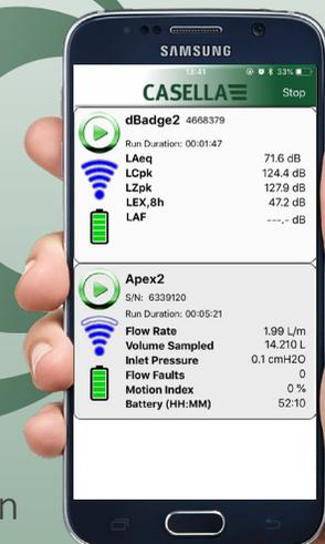
Démarrez, arrêtez et surveillez le dosimètre à distance par le biais d'un appareil iOS ou Android.
