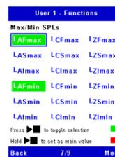
Die tiefgestellten Buchstaben identifizieren die Frequenzgewichtung und die Zeitkonstante, die für die Messung zu benutzen sind und ob die Messung maximal oder minimal ist.
