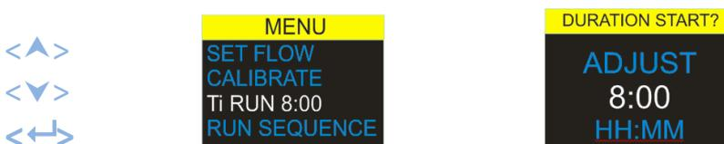
Con el **temporizador de duración de sesión** la bomba puede realizar muestreos durante un período definido para después apagarse automáticamente una vez transcurrido el tiempo especificado. (Modelos Plus y Pro)
