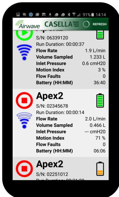
Cuando se abra por primera vez la aplicación Airwave, realizará inmediatamente un escaneo para buscar los productos compatibles con Casella Airwave que se encuentren dentro del radio de alcance (generalmente, dentro de una línea de visión de 25 m sin obstáculos sólidos). Para que un instrumento aparezca en la lista, debe tener activada la función Bluetooth®.
