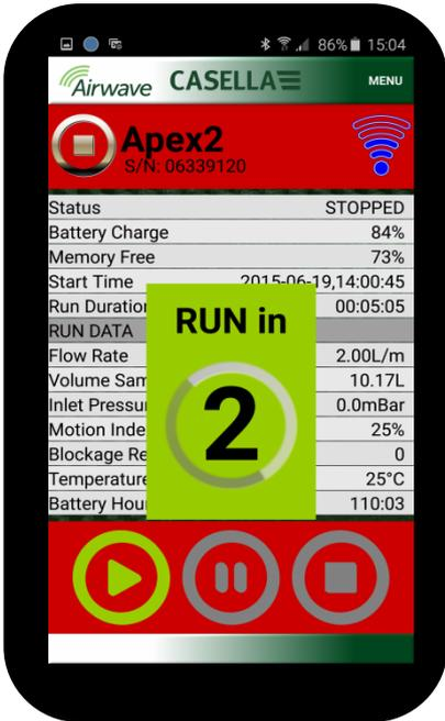
Desde la vista del cuadro de control, toque un instrumento específico para iniciar una conexión directa con el mismo.
