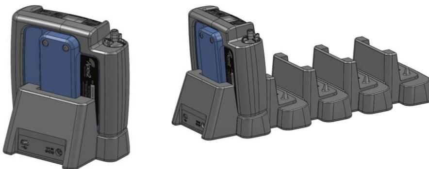
El cargador de una vía se conecta a la corriente con una fuente de alimentación universal PC18 (conector de potencia de 2,1 mm) y la versión de 5 vías utiliza un adaptador PC28 (conector de potencia de 2,5 mm). Se encenderá un LED rojo en la unidad base para indicar que la corriente está conectada.
