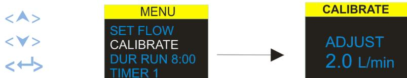
Para realizar una calibración de un solo punto, conecte un cabezal de muestreo, un tubo de caudal u otro dispositivo de medición del caudal a la boquilla de entrada de la bomba, y después seleccione esta opción para calibrar.
