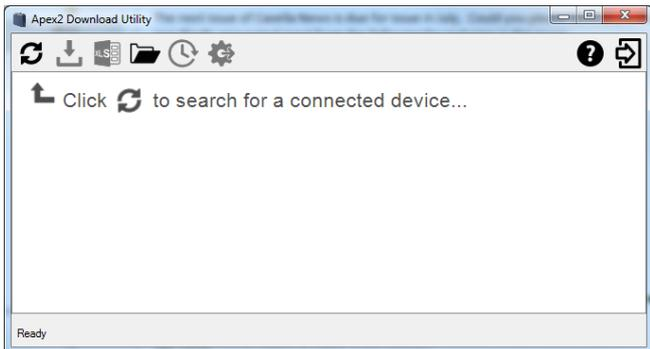
Con la aplicación de descarga abierta, la unidad base conectada a un puerto USB de su P.C, coloque una bomba en el hueco de descarga de la unidad base. Haga clic
