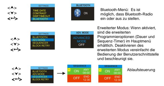
Es ist möglich, bis zu 9 Ein/Aus-Zeiten und Tage einzugeben und somit kann die Apex2 eine automatische Start- und Stopp Probeentnahmereglung verfolgen.
