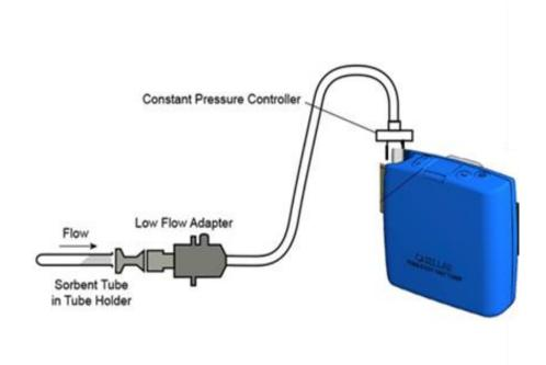
Dies ermöglicht es, das Instrument mit einem Adsorptionsröhrchen bei niedrigen Durchflussraten bis zu 5 Milliliter/Min zu benutzen.
