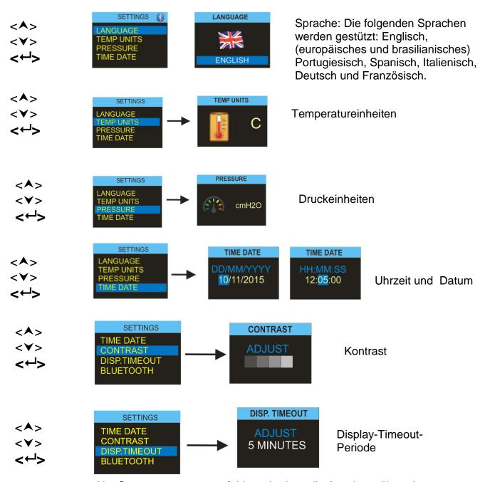
Um Strom zu sparen empfehlen wir, dass die Anzeige während des Pumpenlaufs nicht eingeschaltet ist. Sie kann nach einer vom Benutzer eingestellten Timout-Periode "einschlafen" und wird automatisch nach beliebigem Tastendruck wieder "belebt". Stellen Sie die Uhrzeit auf diesem Bildschirm hier ein.
