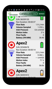
Wenn die Airwave App zuerst geöffnet wird, sucht sie automatisch nach Casella Airwave kompatiblen Produkten innerhalb des Bereichs (typischerweise ab 25m Sichtlinie ohne feste Hindernisse im Weg). Damit ein Instrument auf dieser Liste angezeigt wird, muss zuerst die Bluetooth®-Funktion aktiviert werden.
