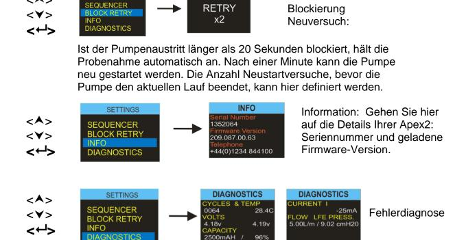
Diese Bildschirme zeigen eine Reihe von technischen Parametern an. Drücken Sie <- >, um zwischen den Anzeigen zu schalten. Diese Information gilt für routinemäßige Wartung und um eine schnelle Fehlerdiagnose zu unterstützen. **Siehe Abschnitt 15 unten**
