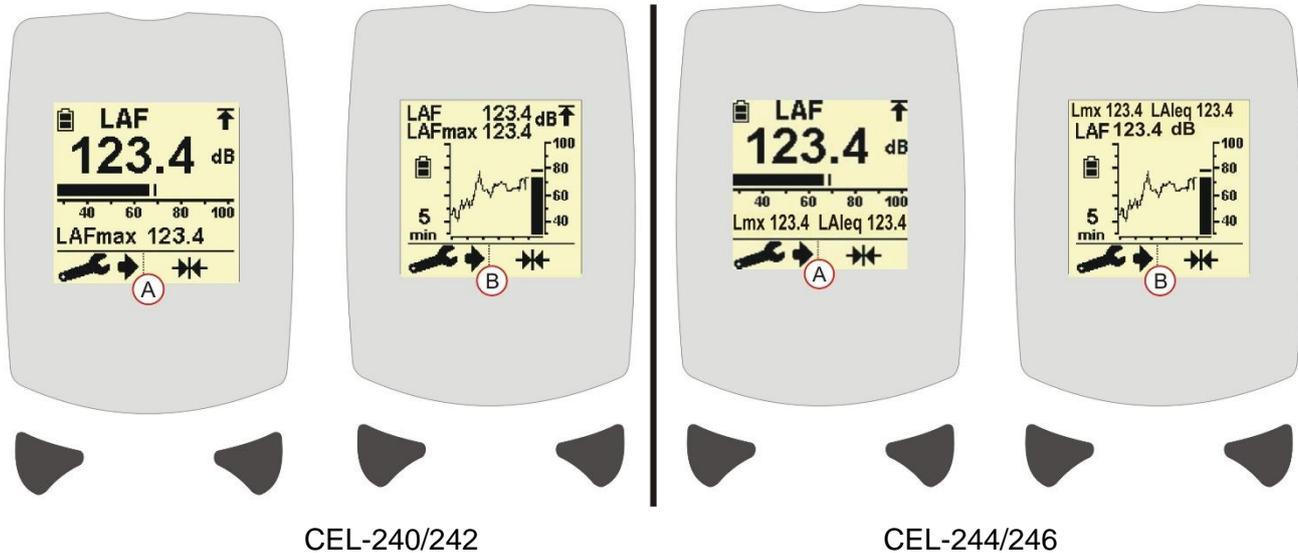
**Abbildung 4 Balkendiagramm und Zeitbilanzanzeigen der CEL-200 Serie**
