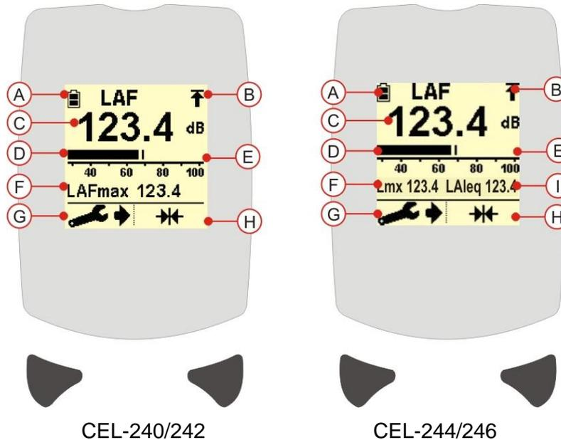
A. – Batteriestandanzeige. B. – Bereich überschritten-Anzeige. C. – Lärmdruckmesser.
