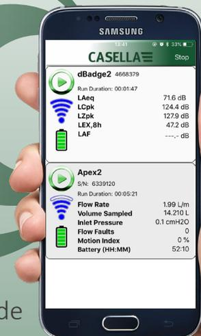
Inicie, detenga y monitorice el dosímetro de forma remota a través de un dispositivo iOS o Android.
