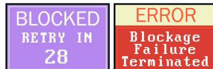
Nach einer Minute versucht die Pumpe, neu zu starten. Wenn die Pumpe nach der festgelegten Anzahl von Neustartversuchen nicht neu starten kann, beendet die Pumpe den aktuellen Probenahmelauf und zeigt eine Fehlermeldung an.
