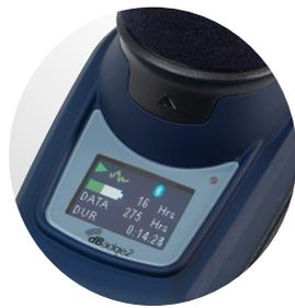
Das intelligente Display zeigt die verbleibende Dauer der Batterielaufzeit und die Speicherkapazität an
