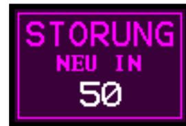
Nach einer Minute versucht die Pumpe, neu zu starten. Wenn die Pumpe nach der festgelegten Anzahl von Neustartversuchen nicht neu starten kann, beendet die Pumpe den aktuellen Probenahmelauf und zeigt eine Fehlermeldung an.
