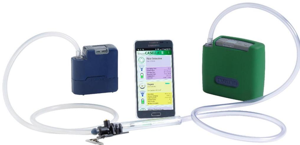
Die VAPex wird mit einer Kalibrierung im geschlossenen Regelkreis dargestellt
