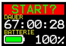
Dies ist eine von drei Instrumententafeln, die nach dem Einschalten der Pumpe erscheinen. Die gleiche Information wird auch angezeigt, wenn die Pumpe in Betrieb steht (siehe *Betrieb* auf Seite 12). Um kurzfristig eine bestimmte Anzeige als Sichtanzeige zu erhalten, drücken Sie und halten die Taste.
