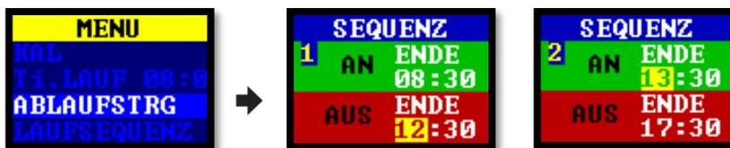
Eine Sequenz läuft, bis eine AUS-Laufzeit auf **BEENDET** eingestellt wurde. Im obigen Beispiel läuft die Pumpe morgens und nachmittags, mit einer Pause von einer Stunde für die Mittagspause des Trägers.
