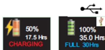
La durée de charge d'une batterie vide à une batterie pleine est d'environ 6 heures, ce qui permet une prise de mesure d'environ 35 heures. Notez que cela vaut en cas d'absence d'enregistrement audio ou d'analyse de la bande d'octave, en supposant que l'écran est éteint 95 % du temps.
