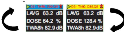
D1 est le dosimètre primaire qui signale les valeurs de dose sélectionnées ainsi que d'autres paramètres de bruit (crête, maximum, etc.) D2 et D3 offrent des indications supplémentaires. La barre d'en-tête pour les mesures de D1 est la couleur de fond d'écran. D2 possède une barre d'en-tête bleue et D3 une barre d'en-tête jaune.
