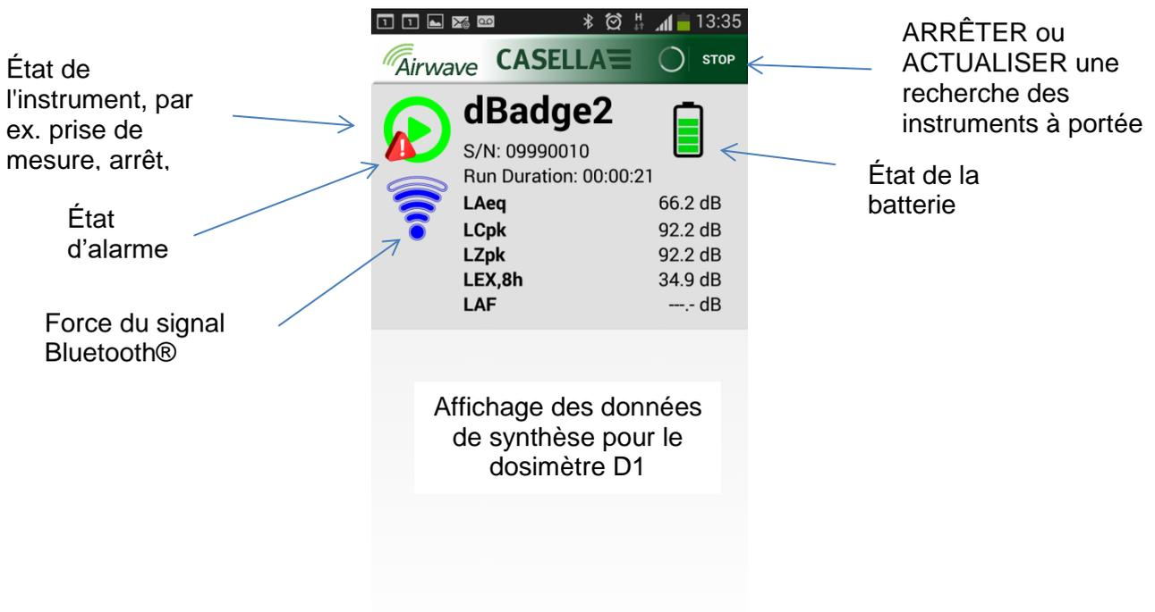
Pour économiser de l'énergie, l'application Airwave arrête le balayage une fois que tous les instruments à sa portée ont été détectés. Pour rechercher de nouveaux instruments, appuyez sur « ACTUALISER » en haut à droite de l'écran de l'appareil mobile.
