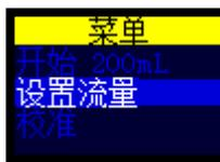
这是您经常用于重置、设置流量和在采样运行之间校准采样泵的菜单。它还允许您访问计时器控制键（请参见第 18 页上的开始启动前的设置和第 21 页上的计时器编程（仅限于专业型））。
