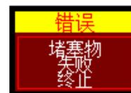
一分钟后，采样泵将尝试重启。如果采样泵在指定的尝试重启次数后无法重启，则采样泵将终止当前采样运行并显示错误消息。
