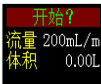
这是您打开采样泵电源后循环显示的三个操作面板屏幕中的其中一个。当采样泵运行时，也显示相同的信息（请参见第 14 页上的操作）。要临时保持单个屏幕作为可视屏幕，请按住 。
