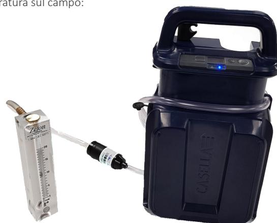
La nostra famiglia per il campionamento dell'aria è completa. Pompe per basso volume (VAPex), medio volume (Apex2) e alto volume (Vortex3)!
