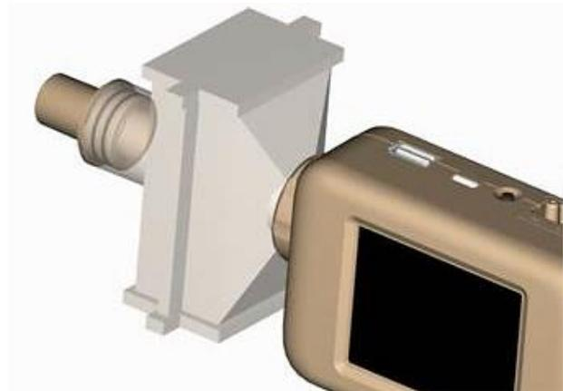
Si les extrémités du tube de 0,5 pouce ou 15 mm sont connectées directement à l'instrument, sélectionnez le commutateur « Using 0.5 inch or 15 mm ends » (Utiliser des extrémités de 0,5 pouce ou 15 mm) dans l'écran des paramètres du compteur.
