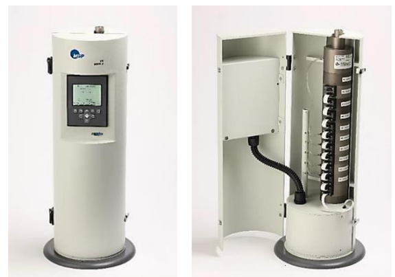
图 3:120R NanoMOUDI 撞击式采样器：外部（左）和内部（右）
