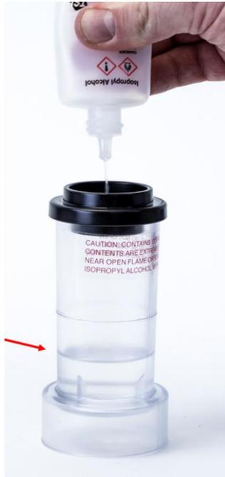
8. Vergewissern Sie sich, dass die Alkoholkartusche sauber ist und setzen Sie die Alkoholkartusche in die Alkoholfüllkapsel ein. Drehen Sie die Kapsel im Uhrzeigersinn, bis sie einrastet.
