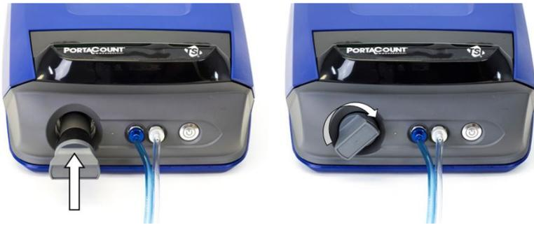
12. Verschließen Sie die Alkohol-Füllkapsel mit der Abdeckkappe, um die Aufnahme von Feuchtigkeit aus der Umgebungsluft und das Entweichen von Alkoholdämpfen zu verhindern.
