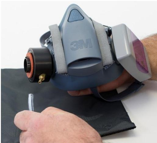
2. Vergewissern Sie sich, dass das Gerät eingeschaltet, die Alkoholkartusche mit Alkohol getränkt und der Doppelschlauch wie in [Kapitel 1](#) beschrieben angebracht ist.
