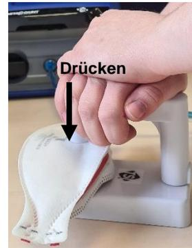
**Schritt 6:** Lassen Sie den PortaPunch™-Hebelarm los, nehmen Sie die Maske ab und überprüfen Sie den Probenahme-Anschluss, um sicherzustellen, dass er fest sitzt und nicht undicht ist. Sie sollten die Sonde nicht mit den Fingern drehen können. Falls erforderlich, verwenden Sie das PortaPunch™-Sondeneinsetzwerkzeug erneut, um den Anschluss festzudrücken.
