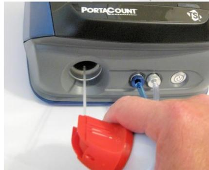
Setzen Sie die Alkoholkartusche wieder ein. Schalten Sie das PortaCount® Dichtsitzprüfgerät ein. Führen Sie die täglichen Checks durch. Wenn das Problem weiterhin besteht, versuchen Sie Verfahren B.
