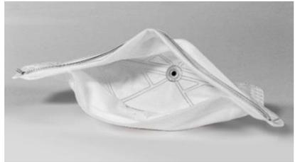
**Flache Masken („Entenschnabel“)**– Installieren Sie die Sonde in der Nähe der Außenkante der **unteren Fläche**, wo sie nicht durch das Kinn der Person blockiert werden kann.
