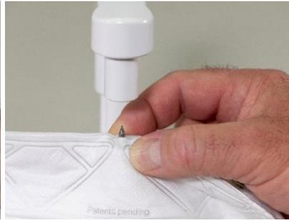
**Schritt 5:** Drücken Sie als Nächstes den PortaPunch™-Hebelarm nach unten, um die Druckmutter an der freiliegenden Stelle, die durch die Maske ragt, einzusetzen, und drücken Sie sie so weit wie möglich zusammen.
