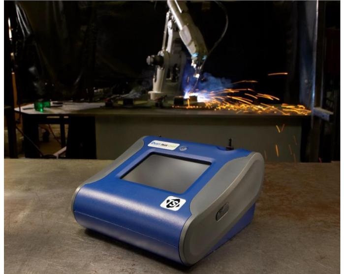
溶接のセットアップが変更されると、DustTrak エアロゾル モニターの測定値がチェックされ、換気制御が適切に配置されて溶接ヒュームが発生点で制御され、工場内のヒュームの蓄積が最小限に抑えられていることが確認されます。DustTrak エアロゾル モニターの携帯性により、機器を使用して特定のワークステーションをスポット チェックし、エアロゾル濃度の高いエリアをトラブルシューティングすることが容易になります。
